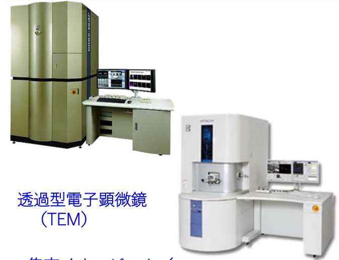
集束イオンビーム/ 電子ビーム加工観察装置 (FIB-SEM)
