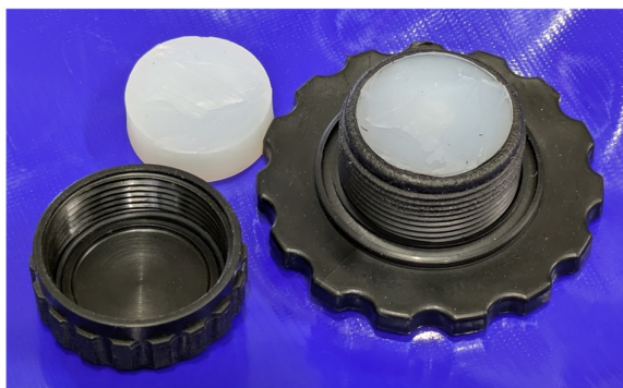
図6 水バッグ給水口の漏れ対策例1 シリコン栓を詰めて余分をカットし蓋をする
