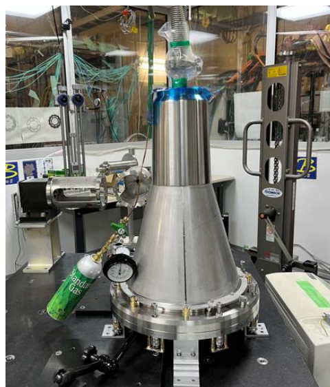
図 10 ヘリウムリーク試験の様子
