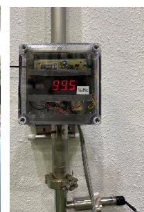
図 5 純度計で回収純度の確認
