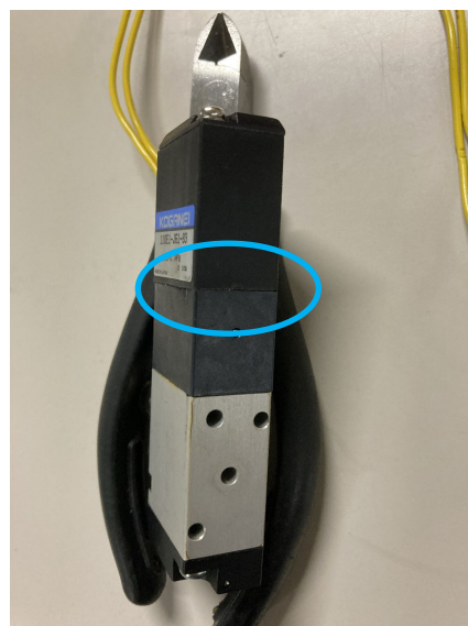
図3 2方弁 3SV のエアー漏れ箇所
