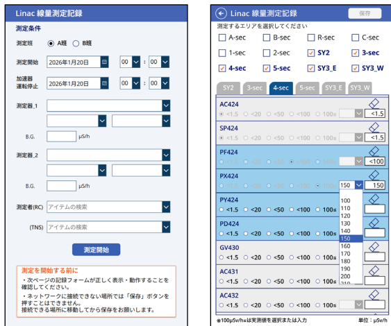
図 2 測定値記録用アプリケーション画面 (左：測定条件画面、右：線量値入力画面)
