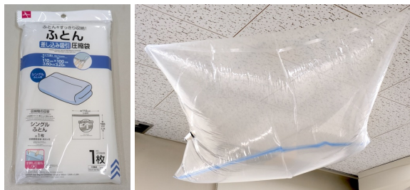
図9 布団圧縮袋でガスバッグを試作
