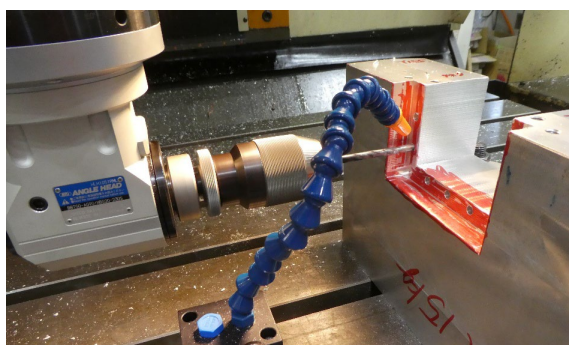
図 5 アルミ治具製作中の様子
