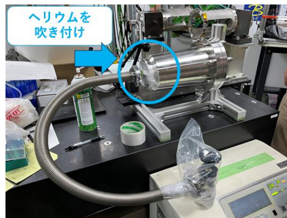
図6 ヘリウムリーク試験の様子
