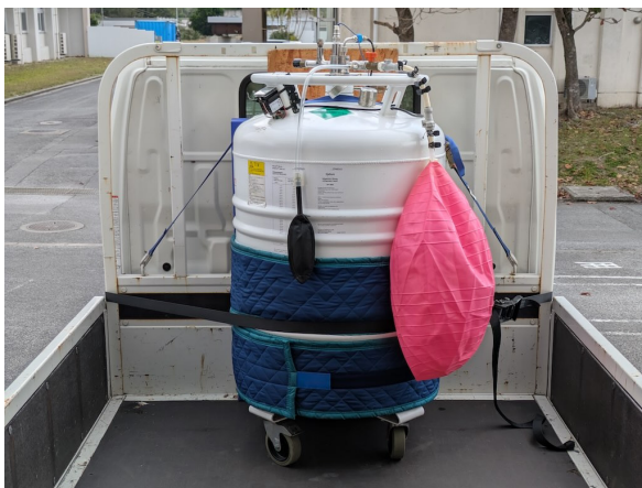
図 11 バランスボールで輸送中のガス回収(実用)
