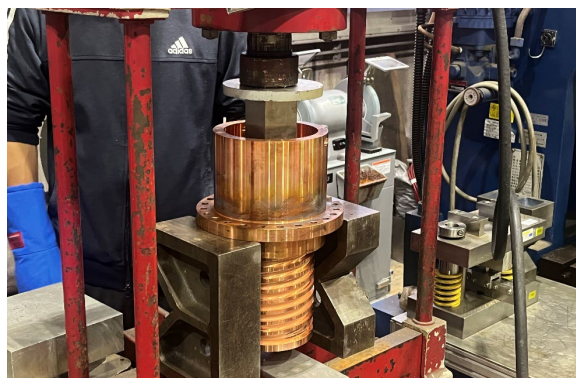
図4 油圧プレスによる取外し
