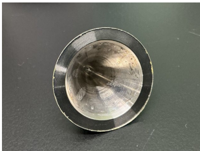
図3 ピットや汚れの発生しているスキマーの様子
