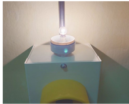
図 5 回転灯改造後のランプ部
