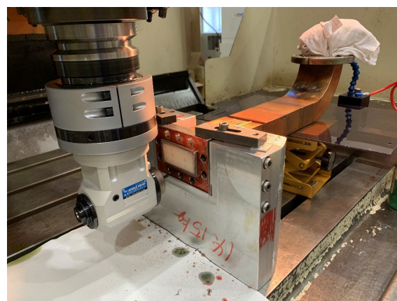
図 6 導波管フランジの加工中の様子
