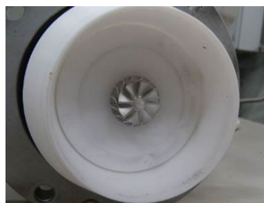
図 2 上:タービン(上側)。下:タービン(下側)。指で触ると抵抗なく回転する。異常はない。
