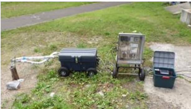
図 3 製作した TRT 装置 (1 号機)
