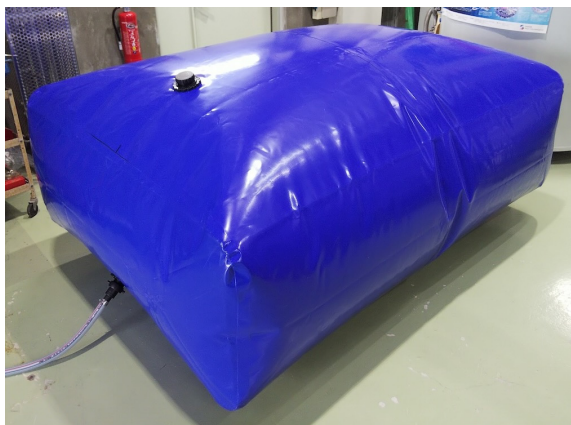
図5 2 m 3 水バッグ(附属のボール弁は不使用)
