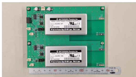
図10 共同開発中のプログラマブル多出力高電圧電源のプリント基板
