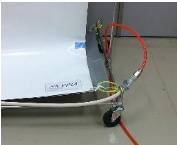
図7 ガスバッグと回収チューブの接続の様子
