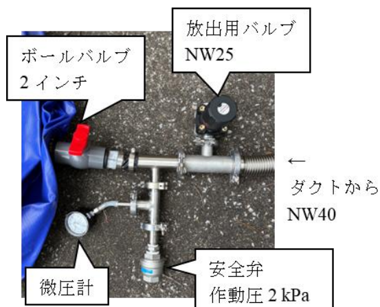
図 1 準備した配管の概要
