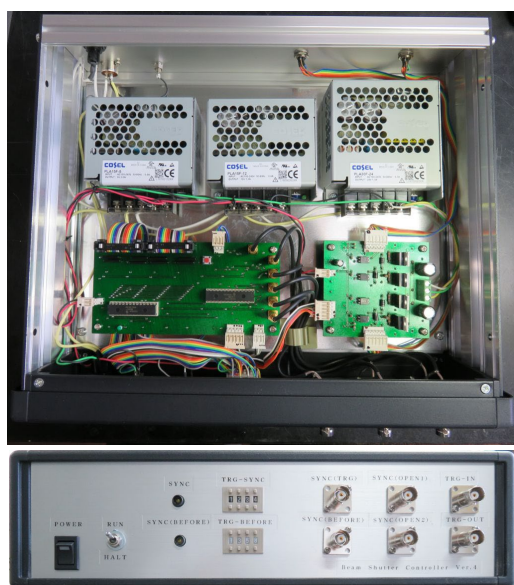
図 1 回路工作室で製作された装置の一例 (ビームシャッターコントローラ Ver.4 1) )
