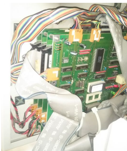
図 3 保管器に内蔵されたオンボードコンピュータ
