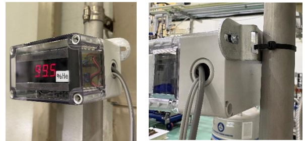
図8 専用部品で配管に設置可能
