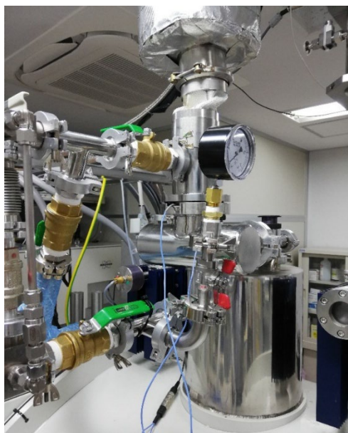
図 4 小動物用 MRI 上部 圧力計取り付け後
