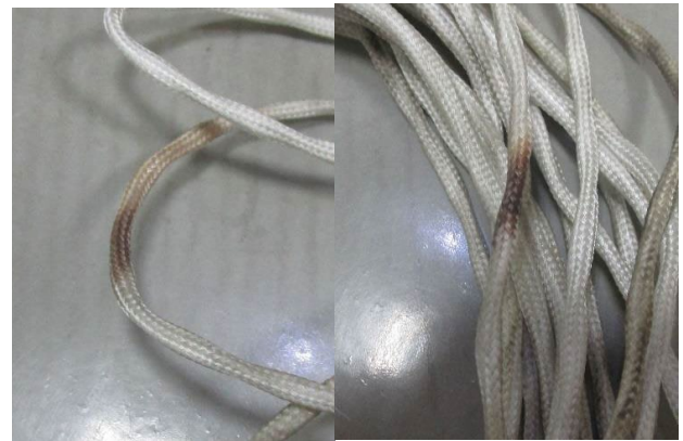
図 4 漏水センサ放電痕
