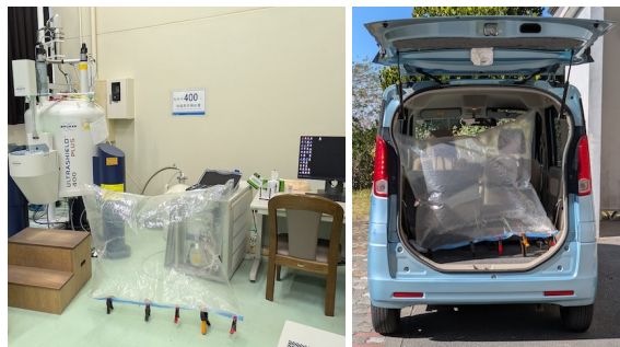
図10 布団圧縮袋でNMR からガス回収(お試し)
