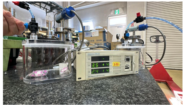
図4 改造した真空容器とコントローラ
