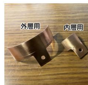
図6 HTSコイルボビン用電流リードの製作結果
