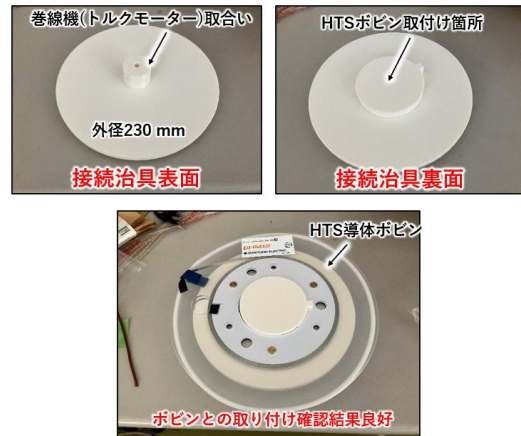
図5 3DプリントしたHTS導体ボビンとトルクモーター間の接続治具
