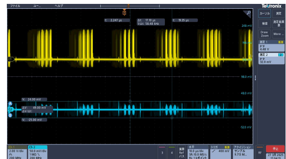
図7 SPI 通信のクロック波形(黄色)と出力に重畳する Voltage fluctuation(青色)
