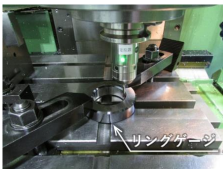
図 8. タッチセンサーによる測定
