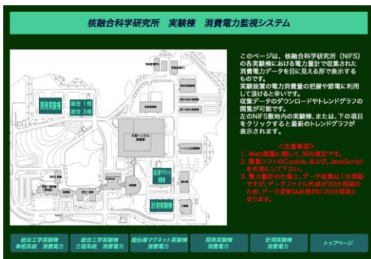
図 10. 消費電力監視システム （トップページ）
