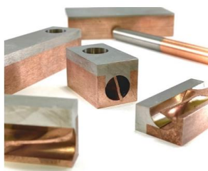
開発した異種金属接合技術PSB法の接合例
