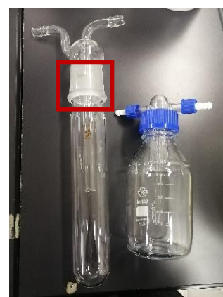
図1. 旧コールドトラップ (左：赤枠内がすりガラス)と 新コールドトラップ(右)
