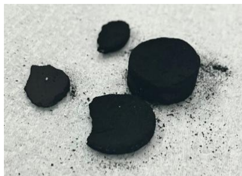
図 4. SPS 焼結後に崩れた活性炭
