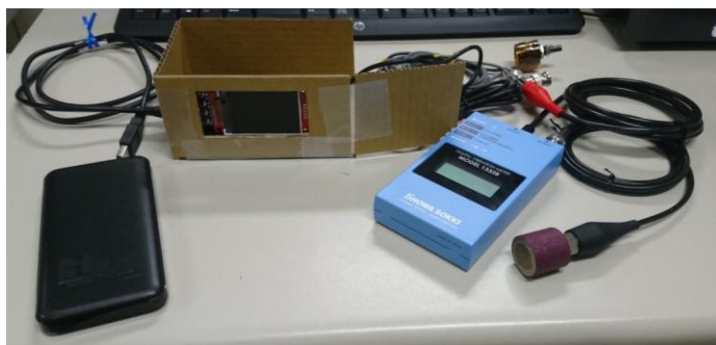
図 2. 振動による AI 故障検知機器構成
