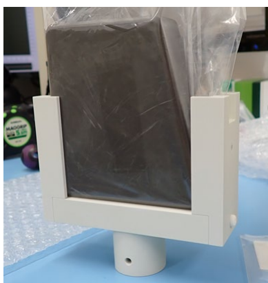
図5：新しく製作した台座に2-3の炭素板を設置した写真
