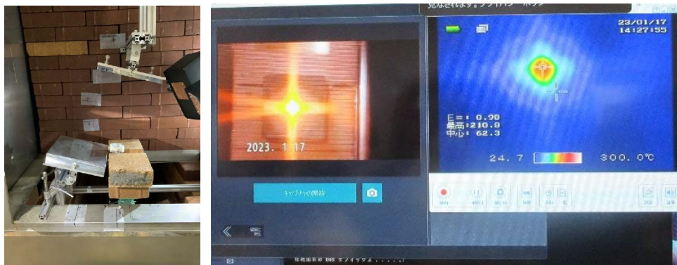
図2. マイクロ波大電力照射設備（左）と試験の様子（右）
