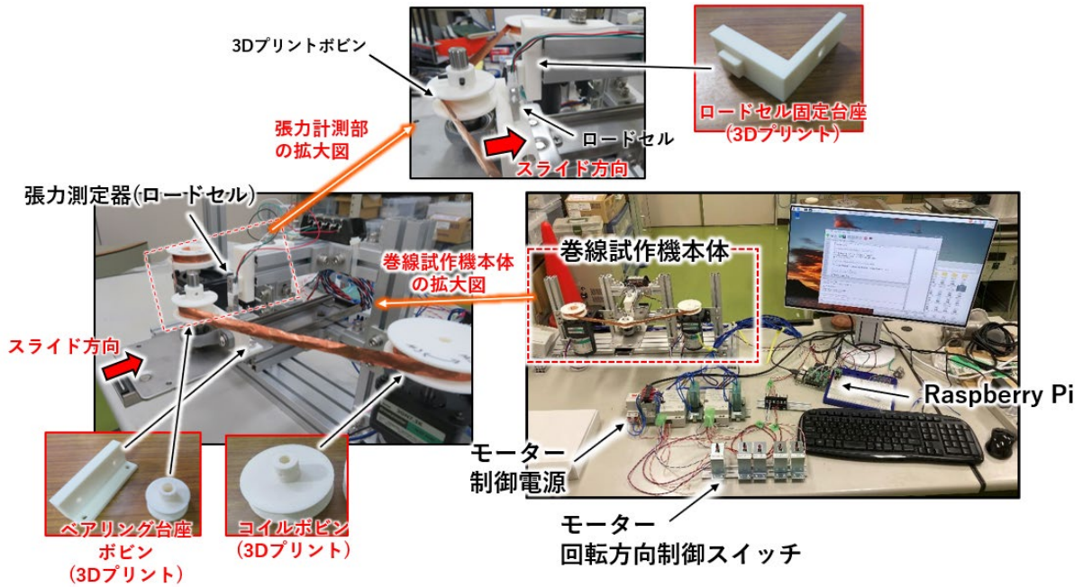
図 2. コイル巻線試作機の製作結果
