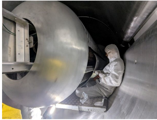
図 2. 加速器内部での作業の様子
