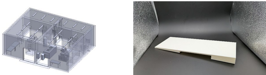
図4. 3DCAD、3Dプリンタを用いた支援 (左) ブースの3Dモデル、(右) 3Dプリンタによるスロープ模型
