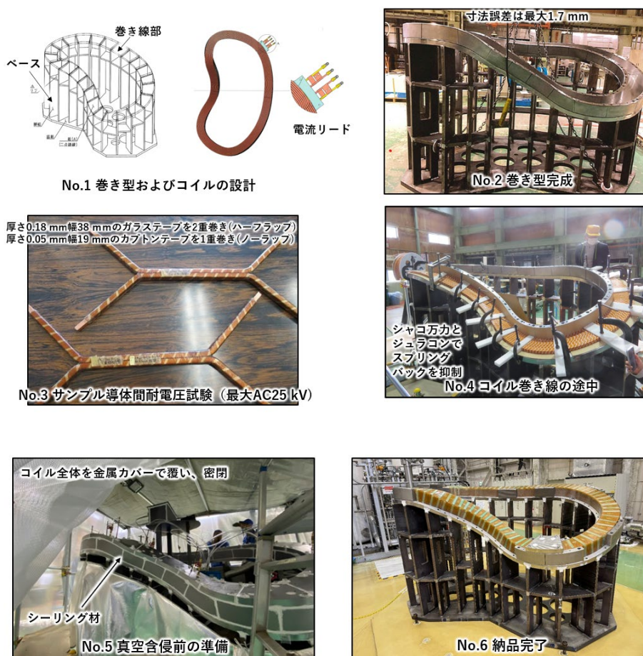
図 2. モジュラーコイルプロトタイプの製作フロー
